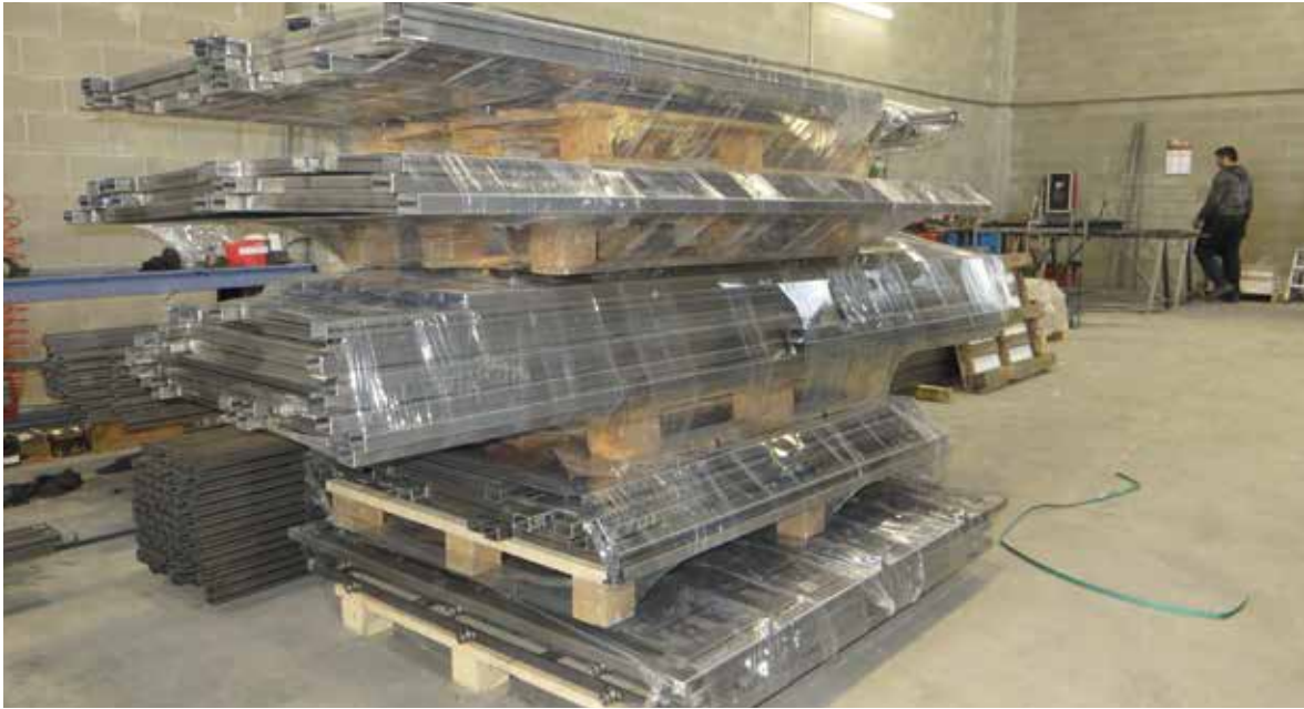
Grate pronte per la verniciatura
